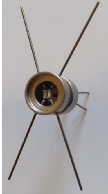
Labormuster Sensor Exhaust mit integriertem Gassensorelement
