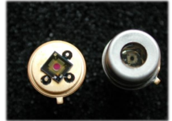
TS80 auf TO39 Sockel und hermetisch verschlossen
